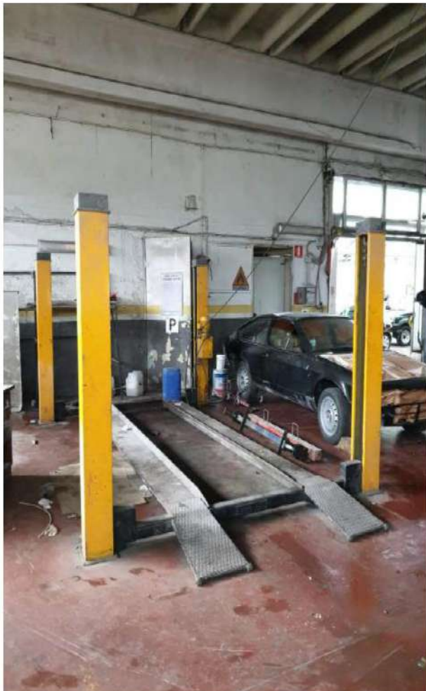
Foto 7. Ponte sollevatore autoveicoli
