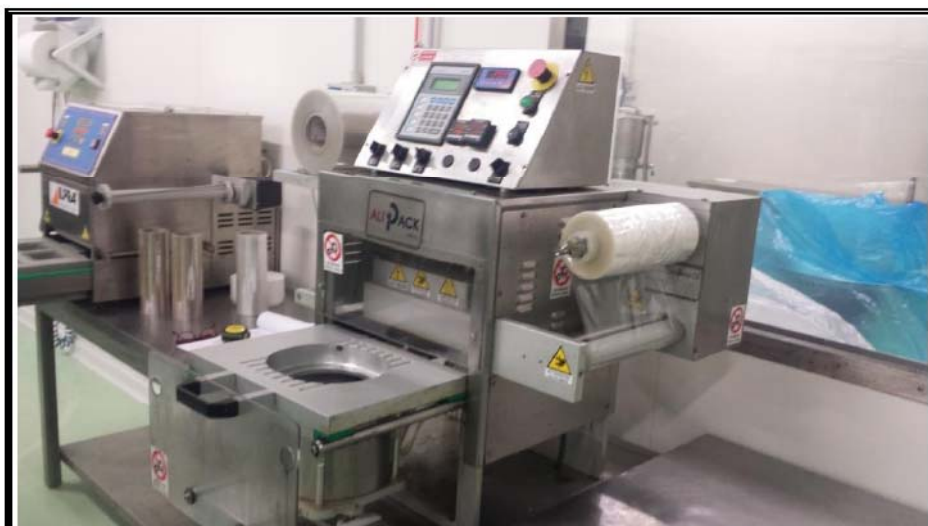
Foto n. 35– Art. 29 – Testa sigillatura vuoto/gas per secchio
