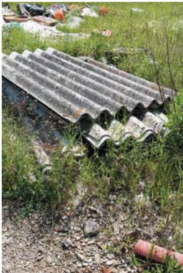
Foto 22. Rifiuti in sito , tra cui amianto
