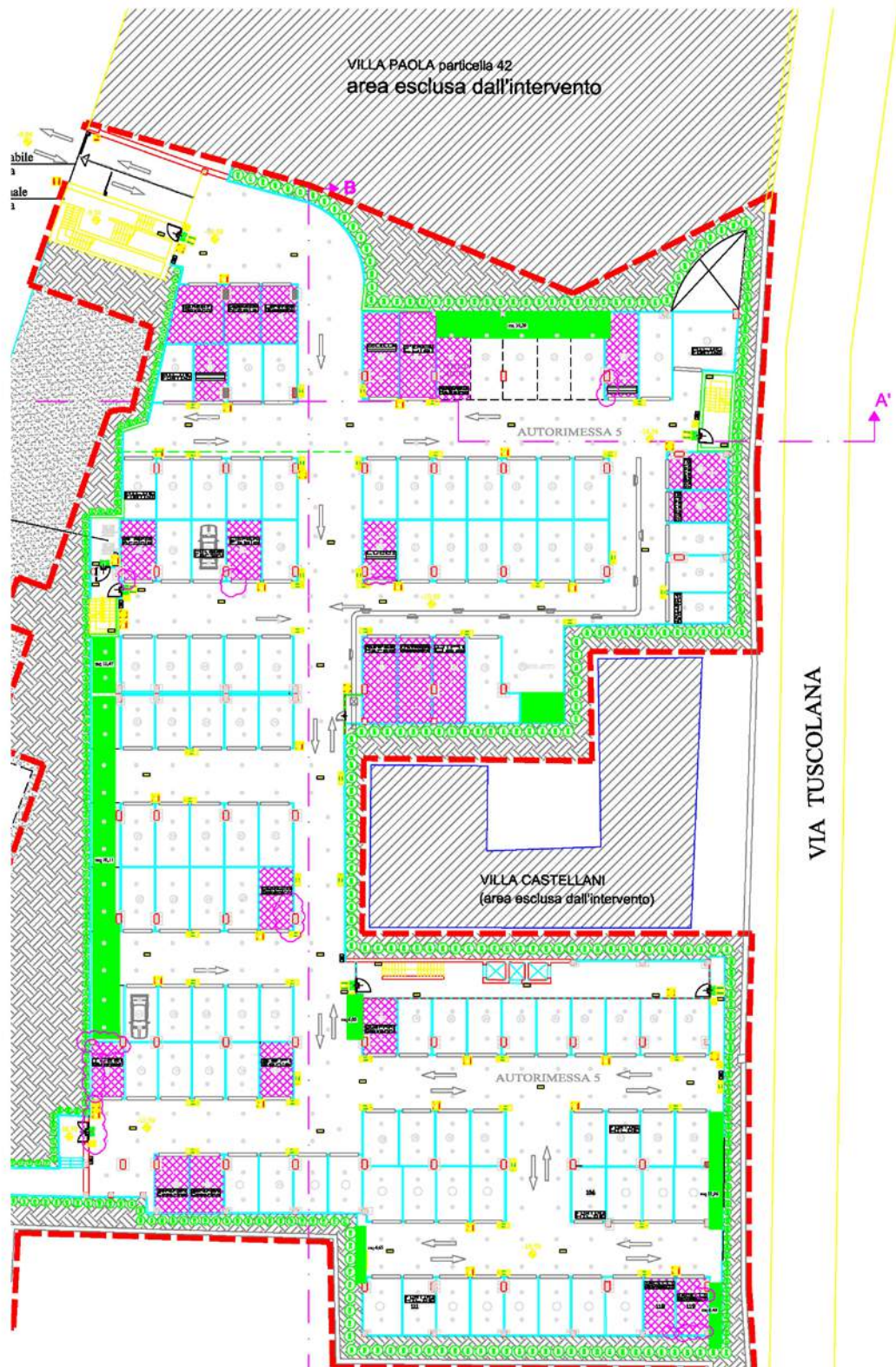
Figura 3: Autorimessa 5. Campiti in magenta i box con infiltrazioni
